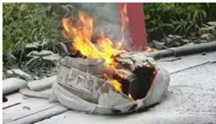
『ゴミ袋内の充電式電池から出火した事例』 (東京消防庁 HP より引用)
