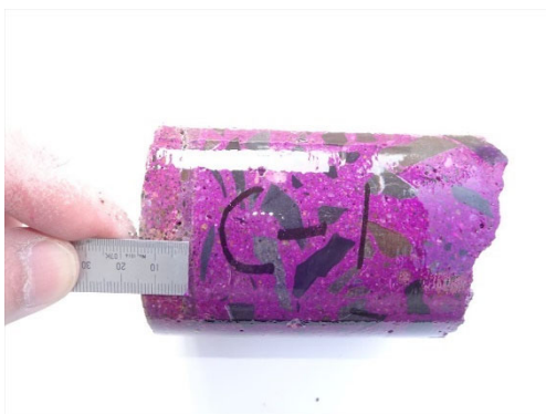
コアによる中性化試験
