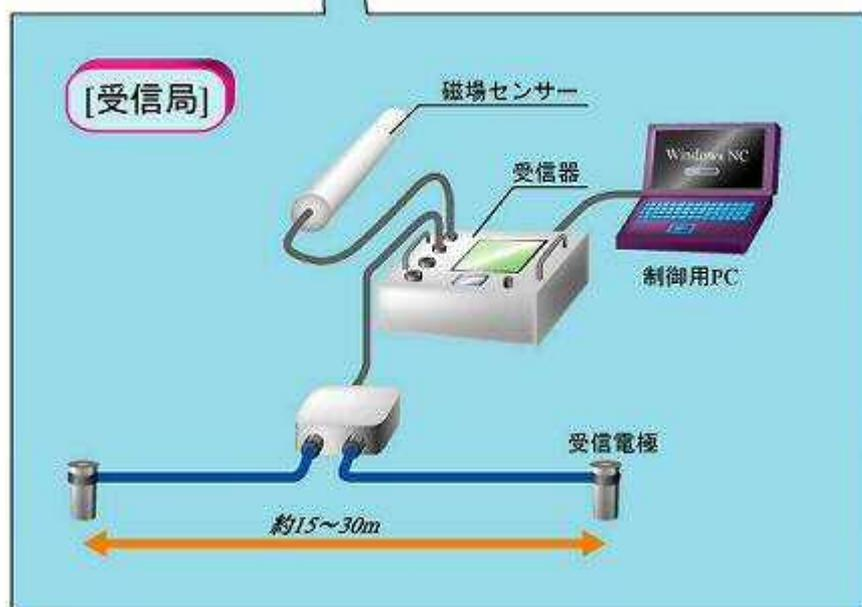
図- 2.3.1 CSAMT 法 電磁探査 測定概念図
