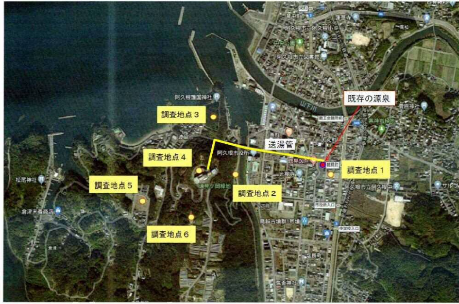
図- 2.3.2 GSAMT 法電磁探査 受信側配置計画
