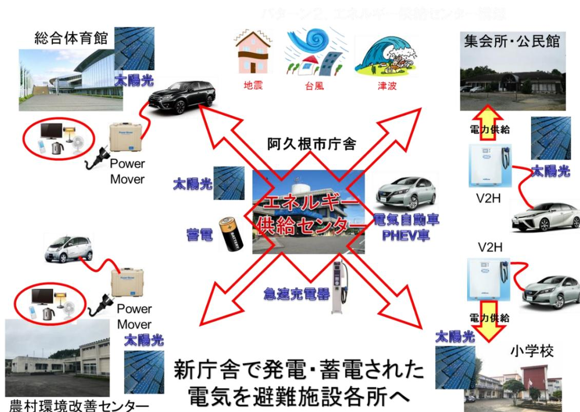
※Power Moverは電気自動車に蓄電された電気を電化製品で使える様に変換する為のシステム。
