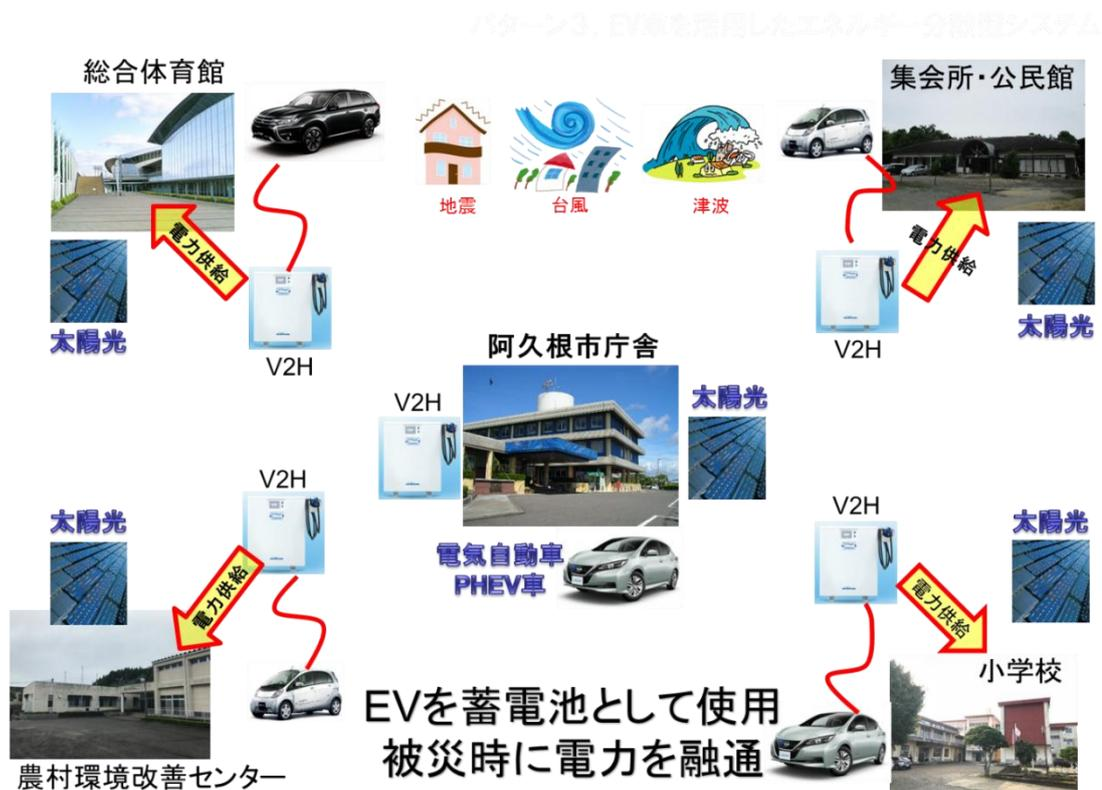
※V2Hシステムは電気自動車に蓄電された電気を小規模施設へ電力供給するためのシステム。
