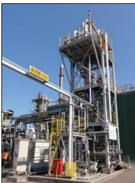
図 3-51 新日鉄エンジニアリング北九州環境技術センター内自己熱再生実証実験装置 56
