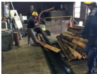
背板をチップパーに投入する様子。
